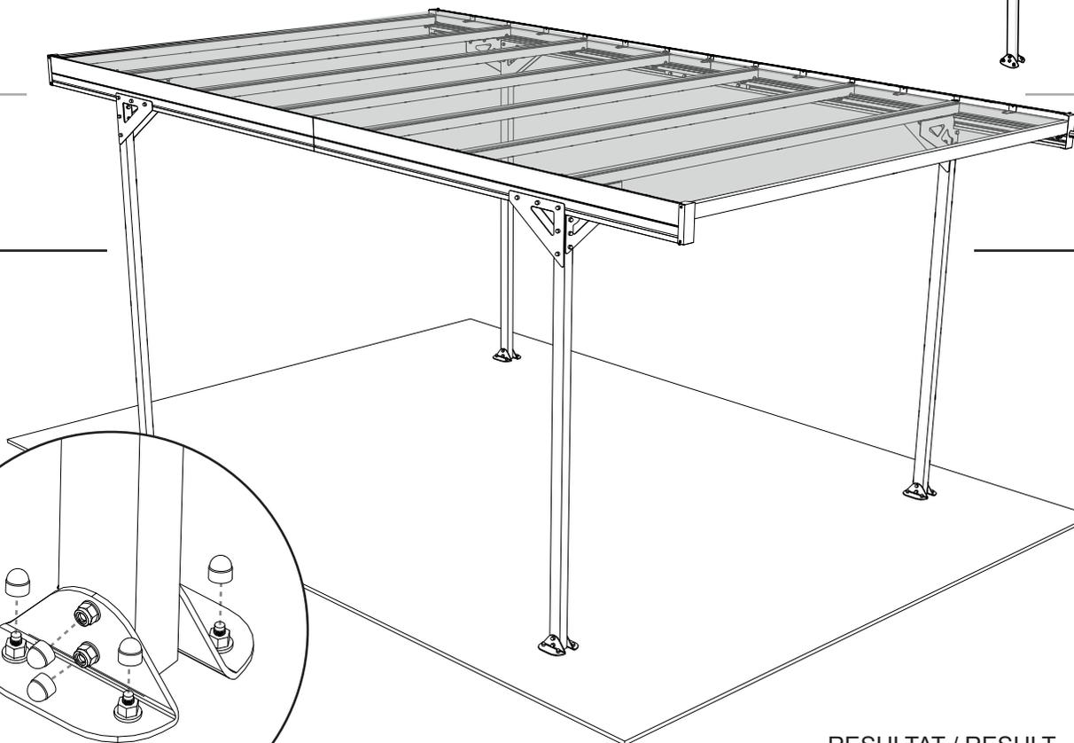
FR : Mettre les caches écrous sur l'ensemble des écrous
